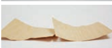
Placage 2 après 5, 10 et 25 minutes de séchage à l'air libre
