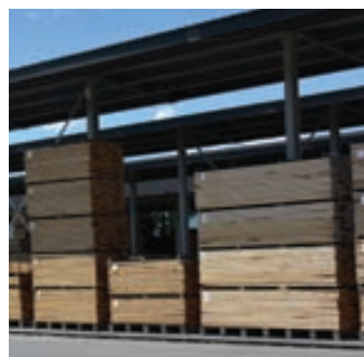
Séchoir extérieur couvert — utilisé pour les séchages simples ou les préséchages
