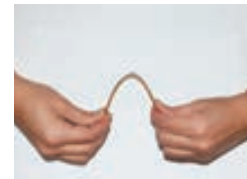
Bâton à café ayant trempé dans un thermos avec de l'eau bouillante pendant 30 minutes
